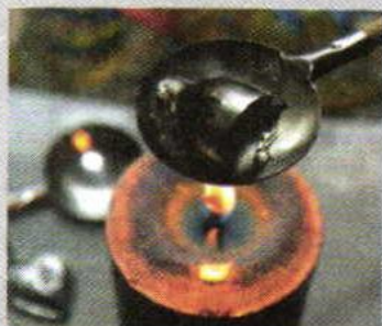
Плавление олова в стальной ложке
