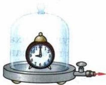
Рис. 80. Опыт, доказывающий, что в пространстве, где нет вещественной среды, звук не распространяется
